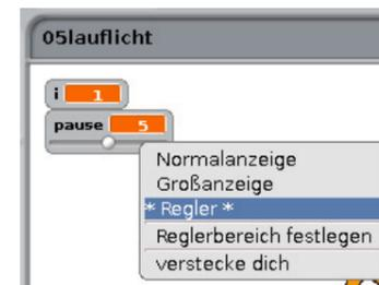
Klicken Sie dann noch auf **Reglerbereich festlegen** und setzen den Maximalwert auf 10, was beim späteren Teilen durch 10 einer Sekunde Pause entspricht.
